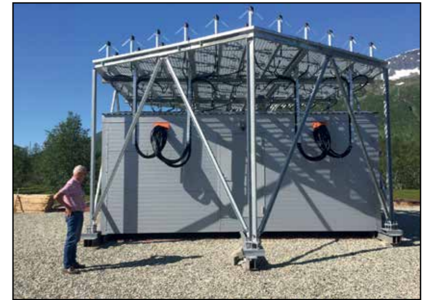
Kuva yhdestä antennimoduulin prototyypistä. Moduulin korkeus on noin 3-4 metriä, koska jokaisen antennitason alle tarvitaan laitetila.
